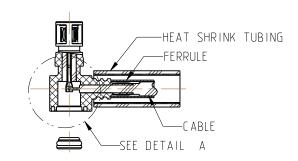
4. SLIDE FERRULE OVER BRAID FULLY FORWARD AND CRIMP TO THE BODY USING HEX CRIMP TOOL PER TABLE ON PAGE 1. THE FERRULE SHOULD BE CRIMPED AS CLOSE TO THE BODY AS POSSIBLE.
