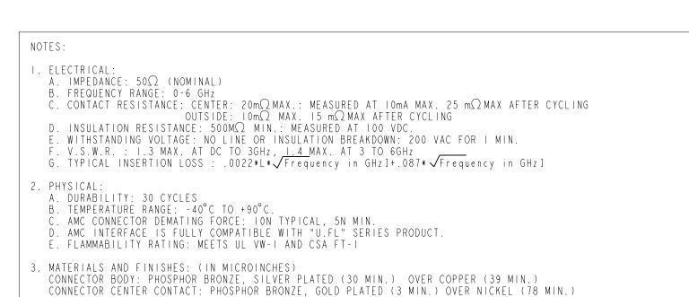
CONNECTOR INSULATOR: HIGH TEMP PLASTIC UL 94V-0, BLACK
